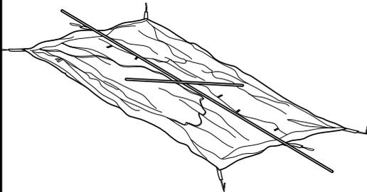
**PFLEGE VON KOHLEFASERSTANGEN:** Zur Gewährleistung der maximalen Lebensdauer von Kohlefaserstangen sollten Sie Druck und Abnutzung vermeiden. Falten Sie die Stangen immer sorgfältig auseinander, und vergewissern Sie sich, dass jeder Abschnitt vor dem Zusammenbau des Zelttes vollständig verbunden ist. Mit entsprechender Sorgfalt halten Kohlefaserstangen genau so lange wie Ihr Zelt.
