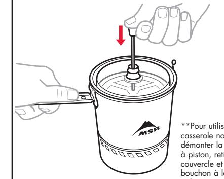
\*\*Pour utiliser la casserole normalement, démonter la cafetière à piston, retirer du couvercle et remplacer le bouchon à la base de la cafetière à piston.
